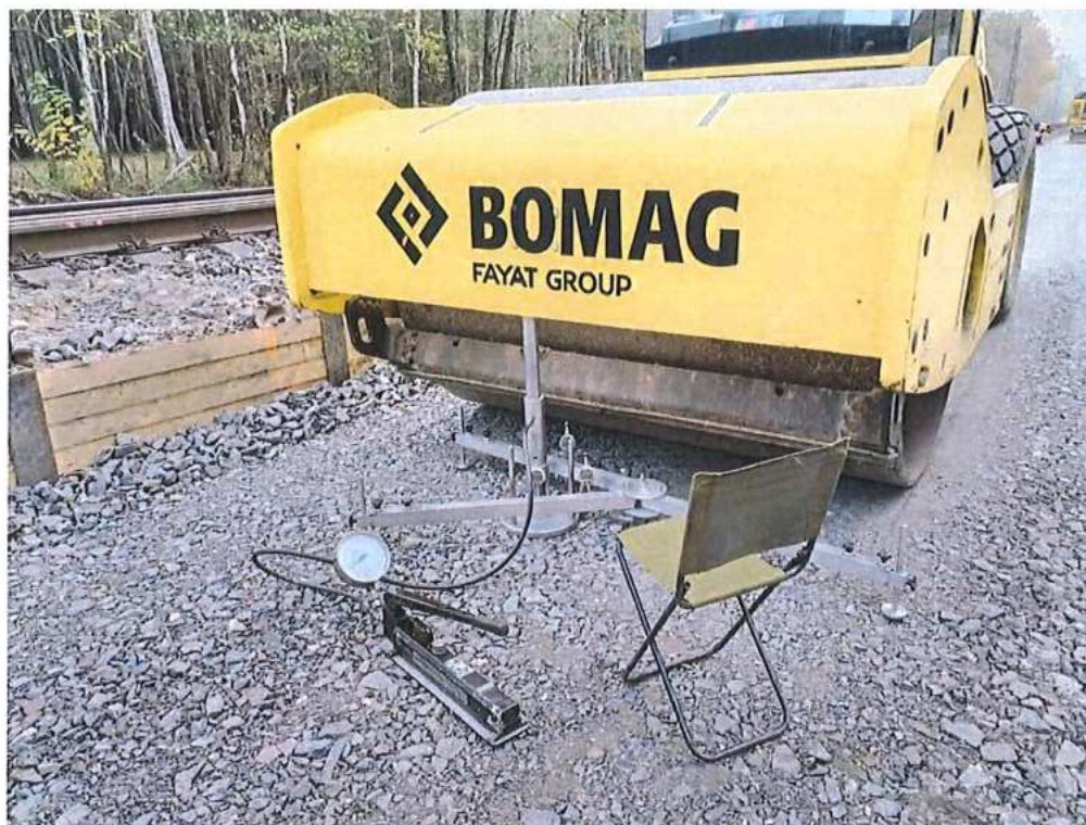
Statická zaťažovacia skúška - SO 10-32-02
