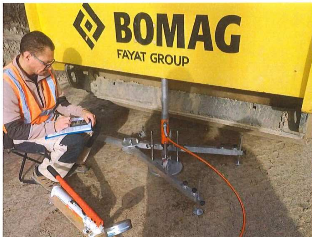
Statická skúška na zemnej pláni – SO 10-32-02
